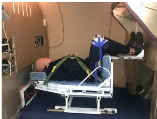
Figure 1. Physical dummy calibration test on a manned centrifuge 图 1. 在载人离心机上的物理假人标定试验
