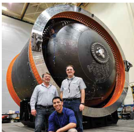
Figure 2. NASA's 5.5 m composite cryogenic storage tank 图 2. NASA 的 5.5 m 复合材料低温贮箱
