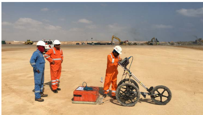
Figure 2. GPR field operation 图 2. 地质雷达探测现场操作
