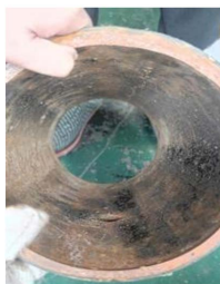
Figure 2. Macroscopic topography of pipe body cavity 图 2. 管体坑洞宏观形貌图
