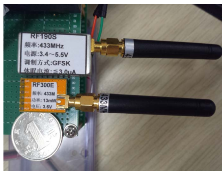
Figure 4. Wireless data transmission module 图 4. 无线数据传输模块
