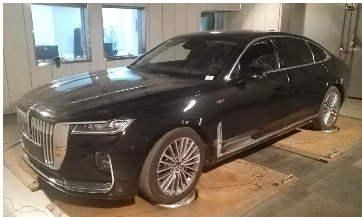
Figure 4. The four-channel road simulation test bench 图 4. 四通道道路模拟试验台架
