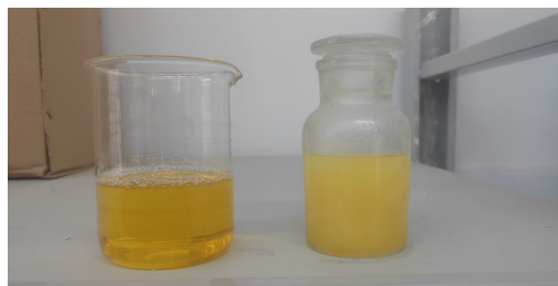
(a) Z厂凝析油常温样品 (b) -17^{\circ}\text{C} 冷冻实验
