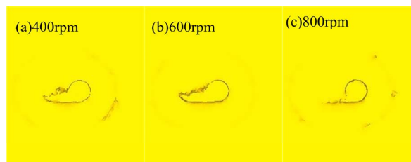
Figure 8. Metal flow trace at different rotation velocity 图 8. 不同旋转速度时的金属流动回线
