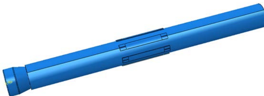
Figure 6. Geometric model of centralizer in Abaqus 图 6. 在 Abaqus 软件中建立的工具的几何模型
