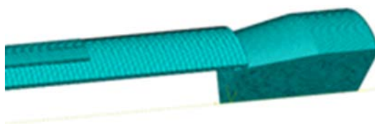
Figure 7. The mesh model of Finite Element 图 7. 在 Abaqus 软件中建立的有限元网格模型
