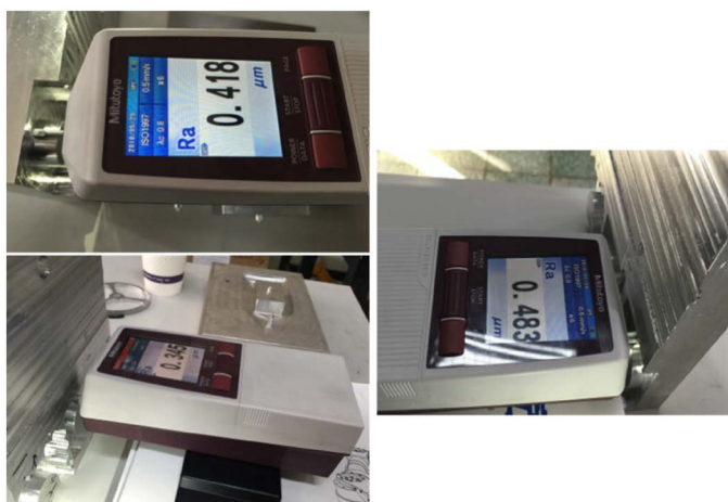
Figure 6. Machined surface roughness values of three groups parameters of cam 图 6. 三组不同加工参数凸轮表面粗糙度值
