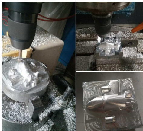
Figure 16. Model plane machining process 图 16. 飞机模型加工过程
