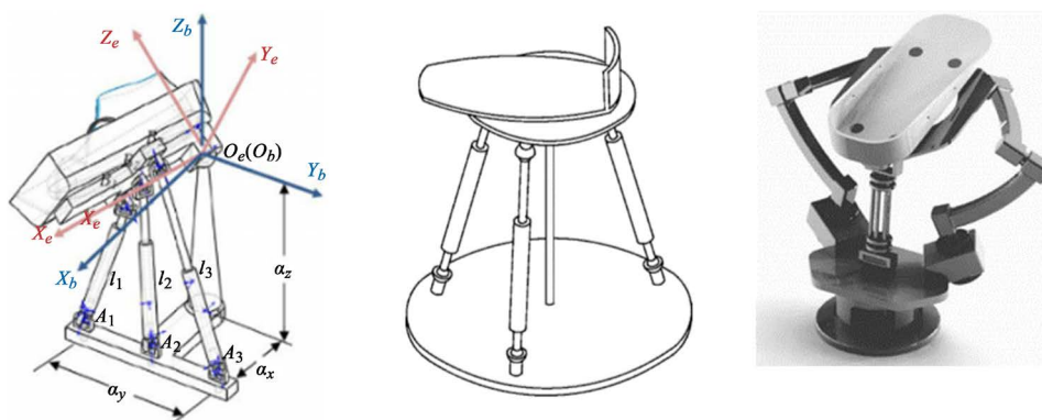
Figure 6. Parallel ankle rehabilitation robot 图 6. 并联型踝关节康复机器人
