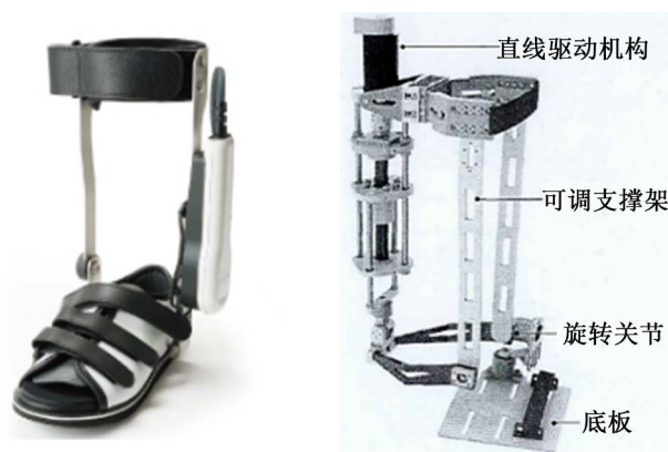
Figure 3. Wearable ankle rehabilitation robot 图 3. 可穿戴型踝关节康复机器人
