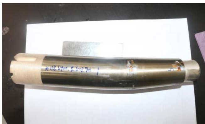
Figure 7. Permanent deformation diagram of test piece 1 图 7. 试验件 1 发生永久变形图
