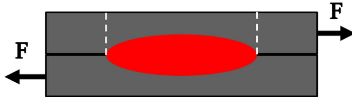
Figure 11. Diagram of pull-out fracture 图 11. 纽扣断裂示意图
