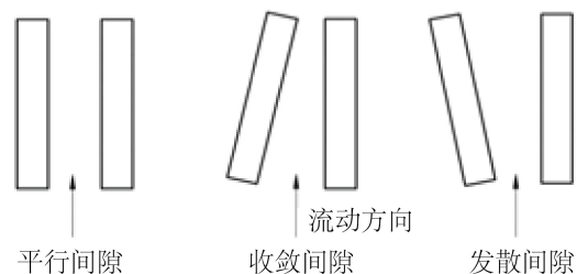
Figure 5. Schematic diagram of end clearance type 图 5. 端面间隙类型示意图
