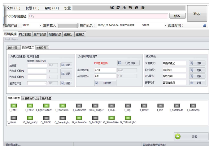
Figure 7. PID control function after equipment upgrade 图 7. 设备升级开发后的 PID 控制功能
