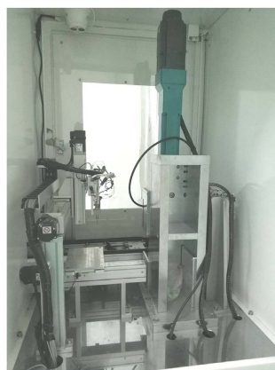
Figure 8. Servo press of automatic pressure equipment 图 8. 自动装压药装置的伺服压机
