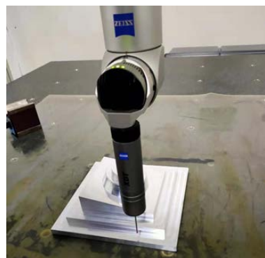
Figure 23. CMM calibration process for feature workpiece 图 23. 特征工件三坐标测量机标定过程
