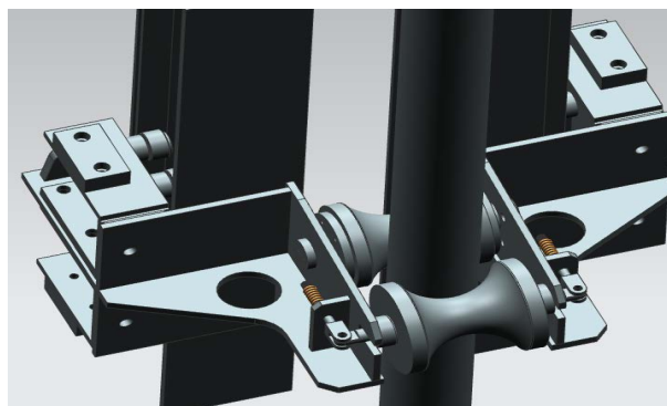
Figure 10. Schematic diagram of outer roller spring 图 10. 外侧辊子弹簧示意图
