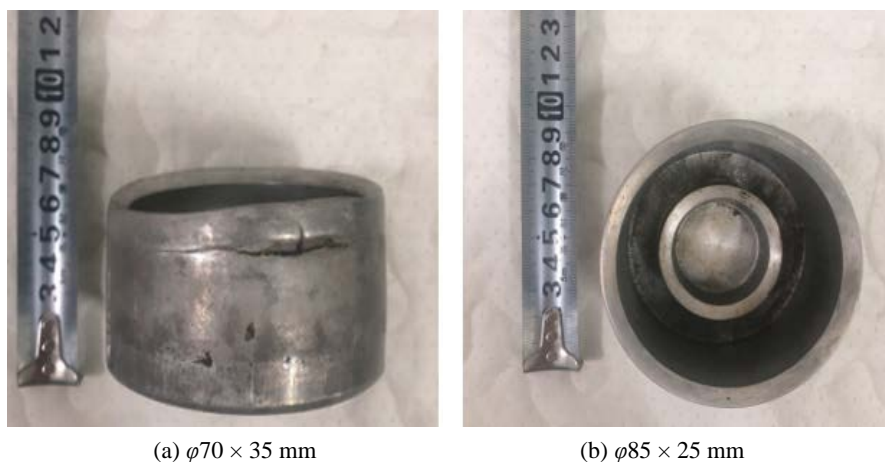
Figure 9. Forming results of different billet sizes at 350℃ 图 9. 温度为 350℃ 时不同坯料尺寸成形结果
