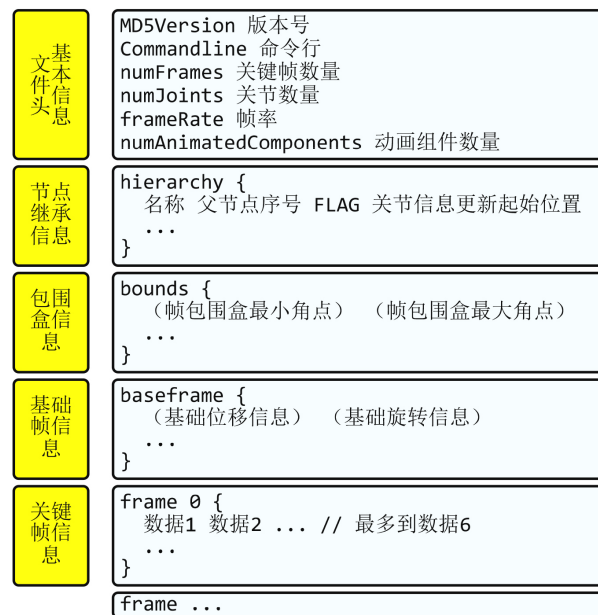
Figure 2. Structure of MD5ANIM file 图 2. MD5ANIM 文件的结构
