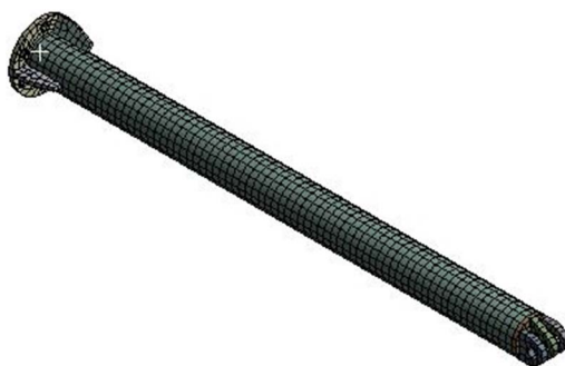
Figure 11. Mesh of parametric modeling of leg 图 11. 支腿参数化建模网格模型
