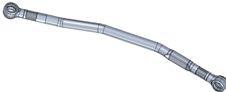
Figure 1. Drag link solid model 图 1. 直拉杆实体模型
