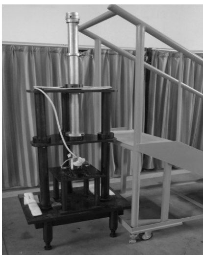
Figure 3. Impact test device 图 3. 冲击试验装置
