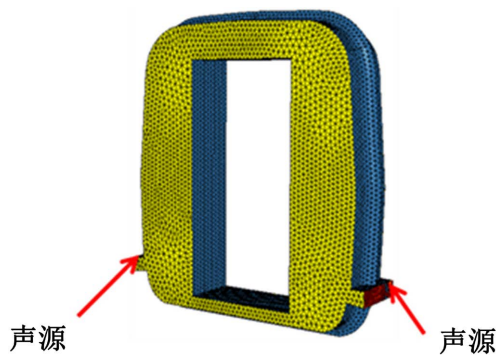
Figure 8. Finite element model for acoustic cavity analysis 图 8. 声腔分析有限元模型
