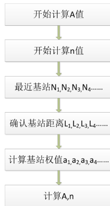
Figure 2. Weighted RSSI algorithm flowchart 图 2. 加权 RSSI 算法流程图
