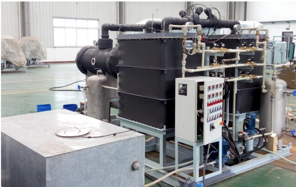
Figure 2. Photo of absorption desalination experimental device 图 2. 吸附式海水淡化实验装置实物图
