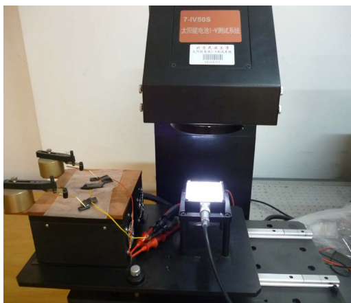
Figure 2. IV characteristics tester of Solar cell 图 2. 太阳能电池 IV 特性测试仪
