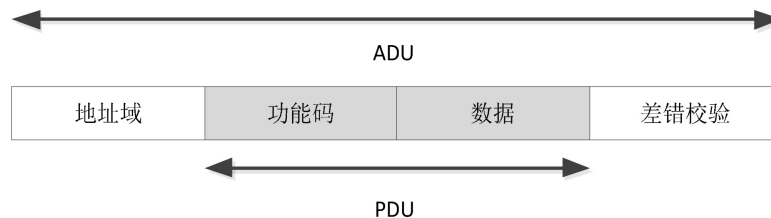
Figure 9. Modbus frame structure 图 9. Modbus 帧结构
