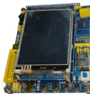
Figure 10. STM32 controller 图 10. STM32 控制器
