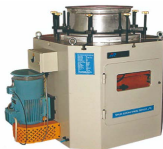
Figure 1. Bending fatigue testing machine 图 1. 弯曲疲劳试验机
