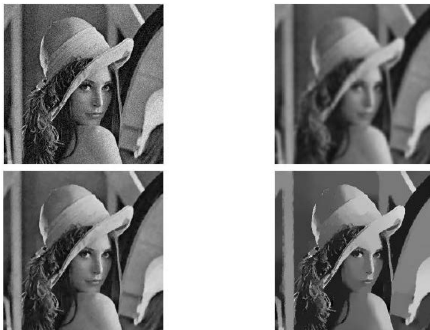
左上图: 256 \times 256 个像素的 Lena 图像; 右上图: Tikhonov 正则化去噪结果; 左下图: TV 正则化去噪结果; 右下图: L_0 稀疏正则化结果
