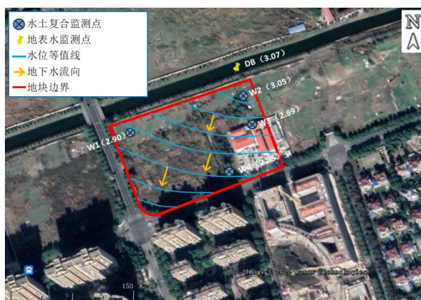
Figure 2. Groundwater flow chart 图 2. 地下水流向图
