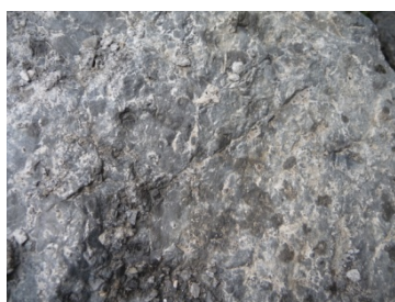
4.什邡磷矿角砾状磷锶铝石矿石，同生沉积碎裂构造，角砾有磨圆和塑性变形。
