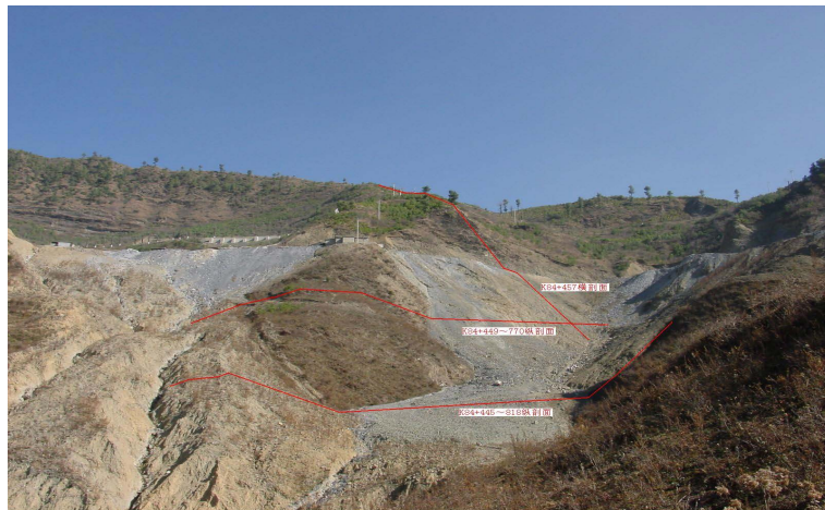
Figure 3. Seismic CT exploration section layout 图 3. 地震 CT 勘探剖面布置示意图
