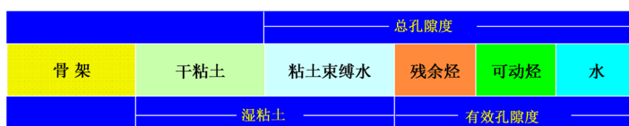
Figure 2. Volume model of dense rock 图 2. 致密岩石体积模型
