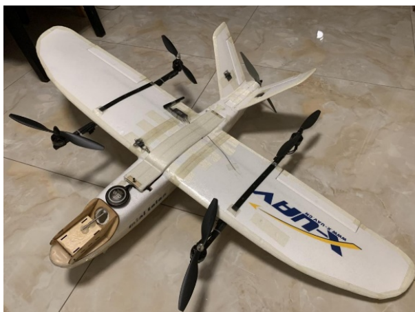
Figure 1. Hybrid drone platform 图 1. 复合式无人机平台
