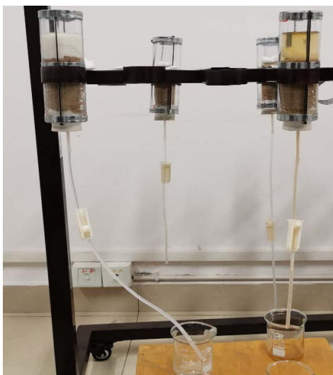
Figure 4. MICP reactor 图 4. MICP 反应装置
