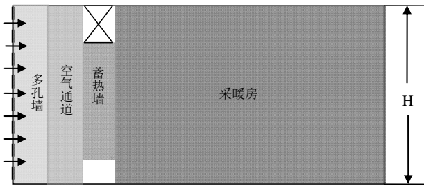
Figure 1. The structure diagram of the solar-wall system 图 1. 太阳墙系统结构示意图
