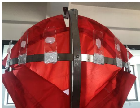
Figure 1. Fixed glass slide wind indicator system 图 1. 固定载玻片风标体系
