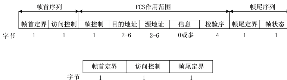
Figure 5. Token and frame format 图 5. 数据帧和令牌的格式
