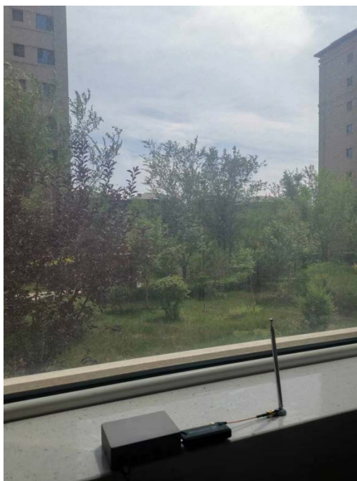
Figure 5. Test system built with Raspberry Pi 4B and DVB-T 图 5. 利用树莓派 4B 和 DVB-T 搭建的测试平台
