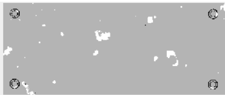
Figure 8. Defect image after dual threshold segmentation 图 8. 双阈值分割后的缺陷图像
