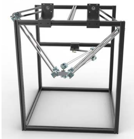
Figure 1. 3D model of 3-RRPaR high speed grabbing parallel robot platform 图 1. 3-RRPaR 高速抓取并联机器人平台的 3D 模型
