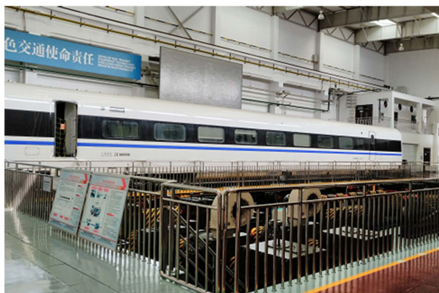
Figure 2. The test-bed of high-speed EMU 图 2. 高速动车组列车试验台
