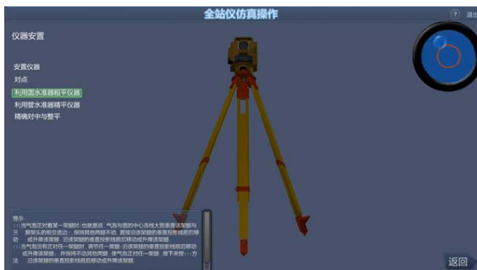
Figure 4. Total station operation interface 图 4. 全站仪安平操作界面
