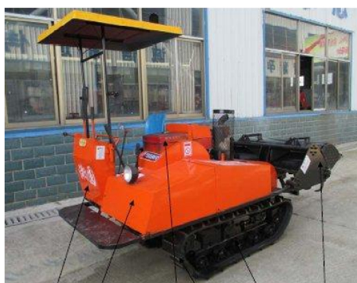
1. 操作台组件 2. 外罩壳组件 3. 柴油机 4. 橡胶履带 5. 底盘总成 6. 旋耕组件
