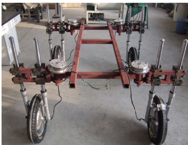
Figure 5. NWAUFU's Flexible robot chassis 图 5. 西北农林科技大学的柔性机器人底盘
