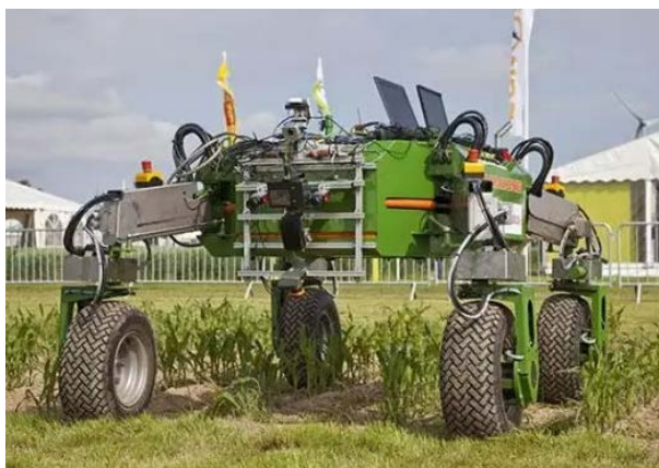
Figure 3. BoniRob intelligent agricultural robot 图 3. BoniRob 智能农业机器人
