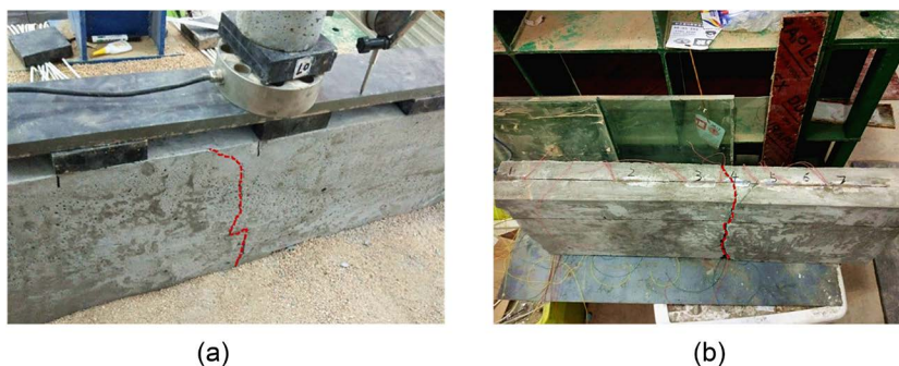
Figure 10. Failure diagram of 40 cm specimen. (a) Side; (b) Bottom 图 10. 40 cm 试件破坏图。(a) 侧面; (b) 底面
