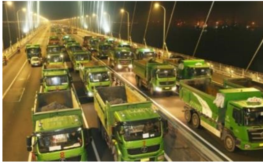
Figure 3. Demonstration of load test 图 3. 加载试验图
