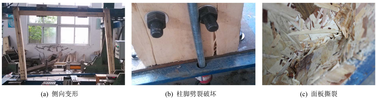
Figure 4. Typical failure modes 图 4. 典型的破坏形式
